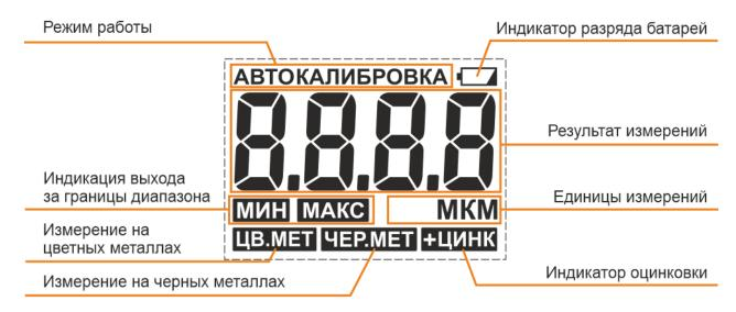
Хотя LCD дисплей изготовлен по технологии FSTN с широким диапазоном рабочих температур, при низких и высоких температурах возможно замедление смены изображения.
