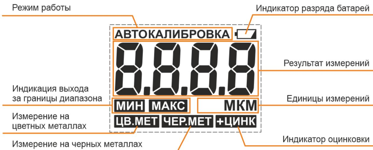
Хотя LCD дисплей изготовлен по технологии FSTN с широким диапазоном рабочих температур, при низких и высоких температурах возможно замедление смены изображения.
