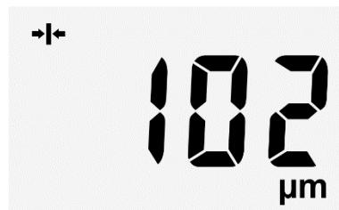
Например, 0, 100 или 1000 мкм. При необходимости повторите измерение. Пока отображается результат измерения, нажимая кнопки «**MODE**» и «**UNIT**» выставите на дисплее толщину измеряемого покрытия. Повторите измерение и откорректируйте при необходимости еще раз.
