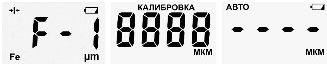
Прибор откалиброван на заводе для основ из материалов сталь ANSI430 (магнитоиндукционный метод измерения) и алюминиевый сплав АМГ2 (вихревой метод измерения).
