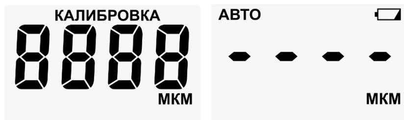
Прибор откалиброван на заводе для основ из материалов сталь ANSI430 (магнитоиндукционный метод измерения) и алюминиевый сплав АМГ2 (вихревой метод измерения).
