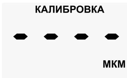
Сделайте измерение на металлической основе без покрытия или вместе с эталонной пластиной известной толщины в пределах от 0 до 3500 мкм.
